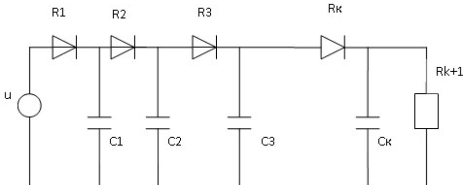
Здесь  $C_j$  - емкость  $j$ -го конденсатора в цепи,  $R_j$  - сопротивления диодов ( $j = \overline{1, k}$ ),  $i_p$  - величина тока  $p = \overline{0, 2k}$ ,  $R_{k+1}$  - активное сопротивление.
